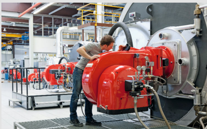
Banc d'essais pour brûleurs moyennes et grandes puissances au Centre R & D Weishaupt
