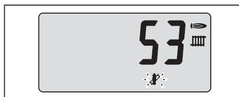
In questo lasso di tempo, ruotando la manopola è possibile entrare nel livello tecnico e riavviare il conto alla rovescia di 2 minuti. Questo permette di eseguire interrogazioni nel livello Info sui valori dell'impianto in relazione alla potenzialità corrispondente.
