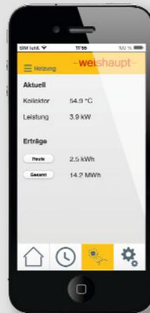
Darstellung der Istwerte einer eingebundenen Solaranlage
