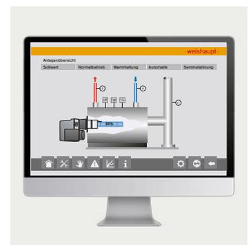
Über optional steckbare Analog- oder Bus-Module ist die Fernbedienung, Ferndiagnose und Fernüberwachung der Anlage möglich.
