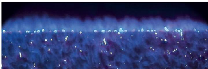
*Das homogene Gas-/Luftgemisch verbrennt an der Oberfläche des Metallgewebes mit Temperaturen < 1200 °C. Durch diese Verbrennungstechnologie wird die thermische NO<sub>x</sub>-Bildung wirksam gehemmt.*
