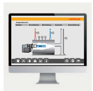
En option, des modules analogiques ou bus enfichables permettent la commande, le diagnostic et la surveillance à distance de l'installation.
