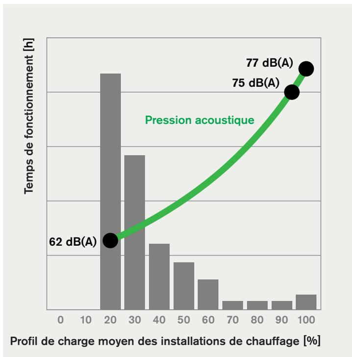
La régulation de vitesse ne permet pas seulement de consommer moins d'électricité. Le brûleur gagne également en silence de fonctionnement.
