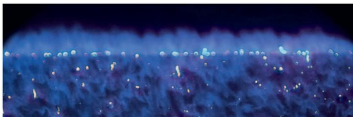
*Des températures < 1200°C résultent de la combustion du mélange air-gaz en surface du tissu métallique. Grâce à cette technique de combustion, la formation de  $\text{NO}_x$  thermiques est inhibée.*
