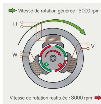
Dans le cas d'un moteur synchrone, le rotor se synchronise à la fréquence et au champ magnétique triphasé dans le stator.
