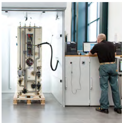
Chaque préparateur multifonction est testé électriquement et hydrauliquement avant la livraison.
