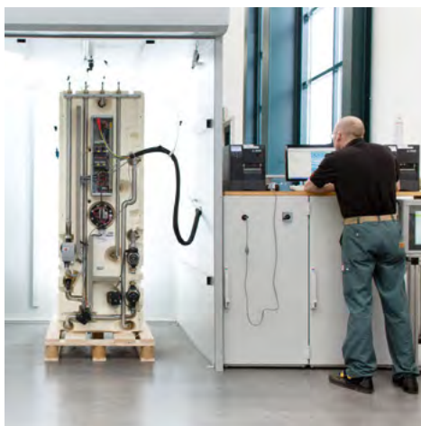
Každý jednotlivý kombinovaný zásobník je pred dodaním elektricky a hydraulicky testovaný.
